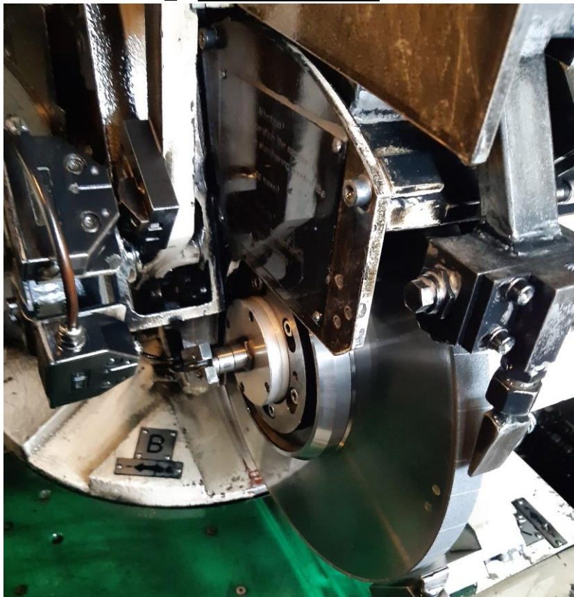
Vista frontal do reboło diamantado com eixo B de giro com movimento por CNC.
